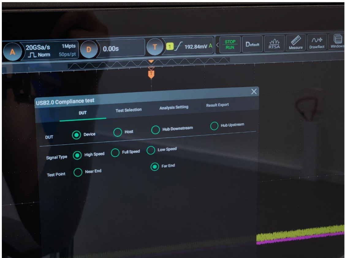
그림 1. DS70000 제품의 USB 2.0 Compliance Test
