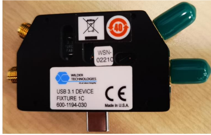
그림 5. RIGOL USB 3.0 테스트 솔루션에 사용되는 테스트 픽스처 1C
