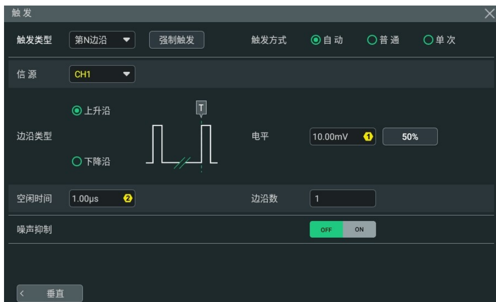
图 8.23 第 N 边沿触发配置菜单
