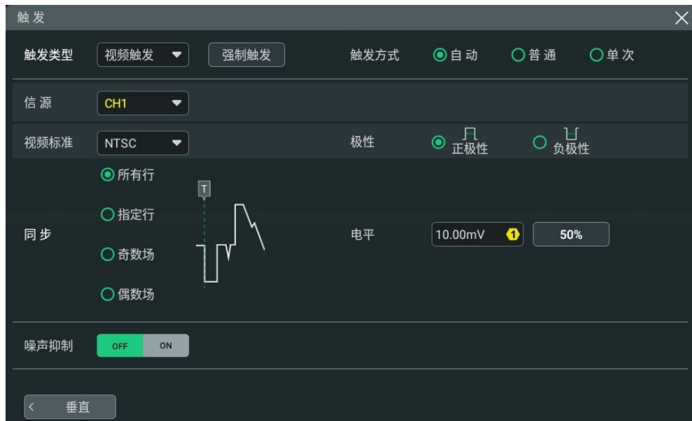
图 8.8 视频触发配置菜单
