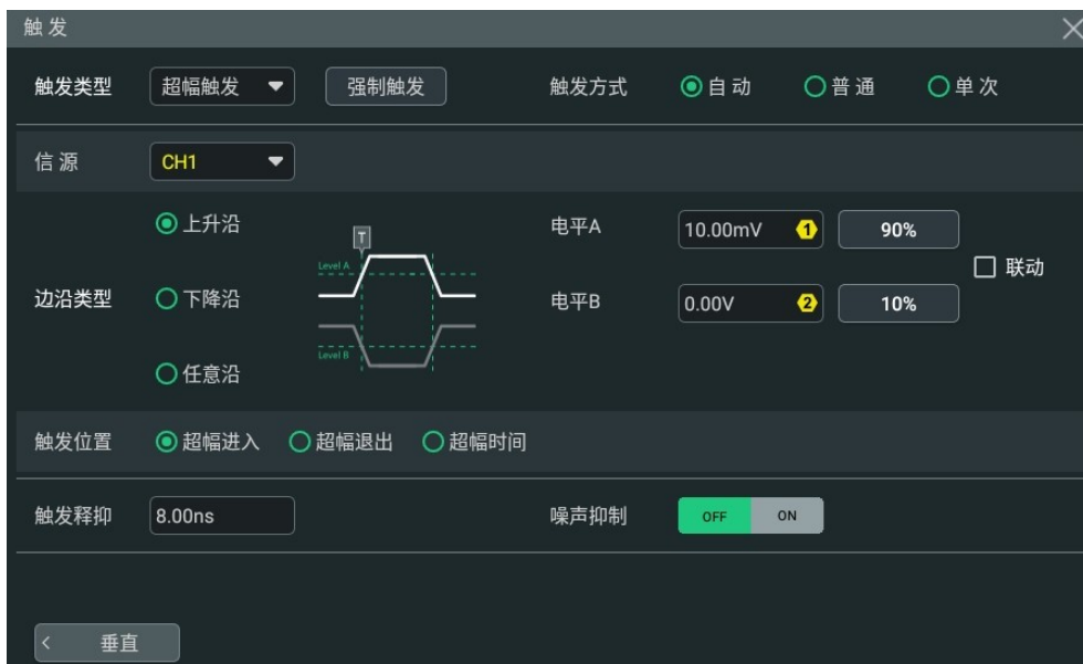
图 8.17 超幅触发配置菜单
