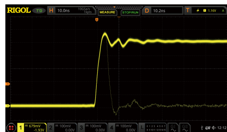
高刷新率模式下捕获偶发异常信号
