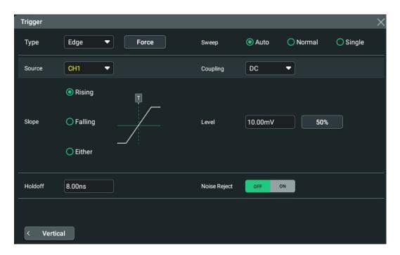
Figure 8.3 Edge Trigger Setting Menu
